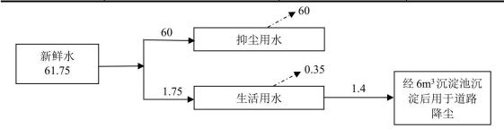
图 2.6-1 本项目工程用、排水平衡图 (单位: m³/a)
